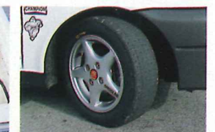
▲これは輸入されたばかりのほう。スピードライン製の5J×13サイズのホイールに組まれるタイヤは、ミシュランの13/53-13と表示された、ほぼスリックといえるもの。乗り心地は意外と悪くない。
