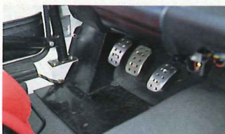
▲ベタル類はトロフェオのキットパーツのひとつ。実践経験ありというトロフェオは、ご覧の通り、大型フットレストを設けている。
