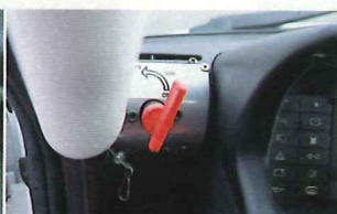
▲キルスイッチは、ダッシュボード左側のエア吹き出し口を塞ぐような格好で取り付けられていた。これも実践経験を物語る。
