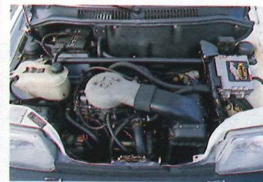
▲エンジンはヘッドが専用設計、カムシャフトのプロファイルも変更されている。圧縮比10.2で、最高出力55ps/6500rpm、最大トルク7.9kg-m/4000rpmというスペックだ。
