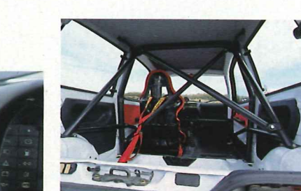
▲ケージはダイアゴナル構成で、これでボディ剛性をかなり高めているようだ。このシートはイタリアから輸入されたもののようで、このようにシングルシート仕様だったという。
