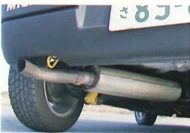
▲手曲げで、ひとつひとつ作られていることが、パイプのしわやタイコの溶接の具合で分かる。これが、実に小気味のよいサウンドを叩き出すのだ。
