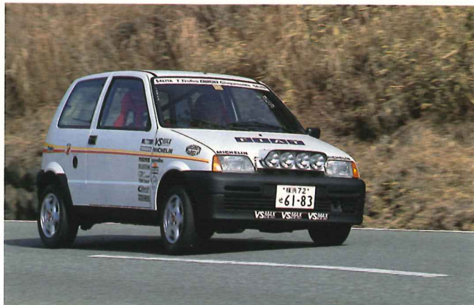
▲緩い下りのコーナーを、快音を響かせ、駆け降りてくるトロフェオ。ワインディングの下りはこのクルマの最も得意とするところ？ ギア比はノーマルと変わらないが、デフのギア比は4.46と低く、高速巡航は5速をもってしてもツライのだ。そのスタビリティは高いが、音に負ける。
