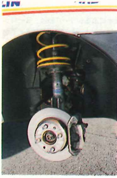
▲黄色のスプリングはアイバップハ製、ショックアブソーバーはシルシュタイパン製、組み込まれるブレーキパッドは、フェロード製、スベサーの厚さにも注目されたし！
