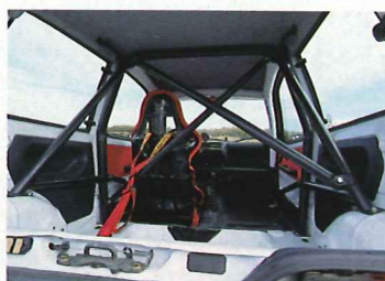
▲ケージはダイアゴナル構成で、これでボディ剛性をかなり高めているようだ。このシートはイタリアから輸入されたもののようで、このようにシングルシート仕様だったという。
